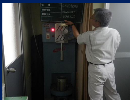
土の締固め試験
