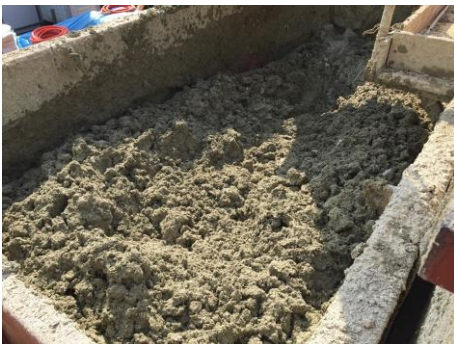
④ MT-2 の成分が土粒子同士を絡め、団粒化
