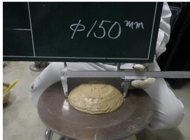
写真-5 運搬可能な性状 (150mm/50 回落下時)
