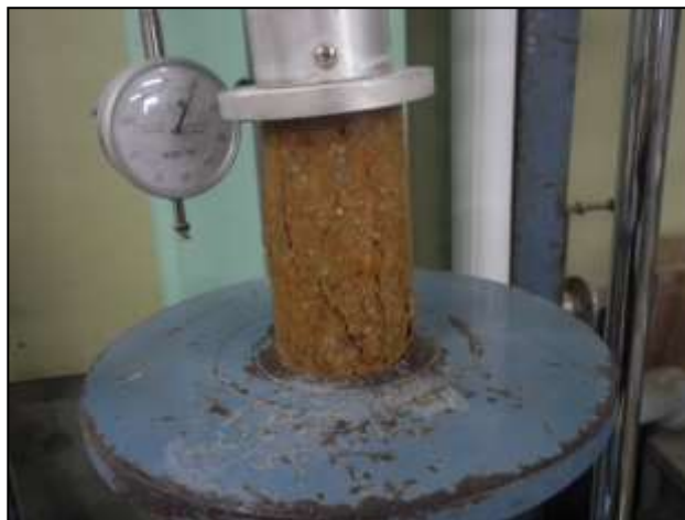
写真-6 原泥の一軸圧縮強度試験
