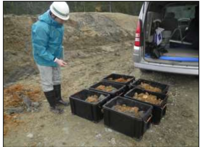
写真-3 改良対象土の採取状況
