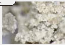
固化材だけの土粒子間結合力
