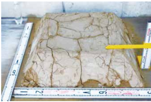
安定処理土のひび割れ
