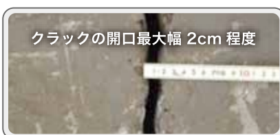
安定処理土のクラック発生状況 (クラック調査による石灰水投入後の染み出し状況)
