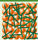
固化材と繊維が複雑に絡み合う土粒子間結合力
