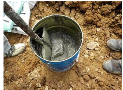
採取泥土を柄杓やスコップで混合(均一化)
