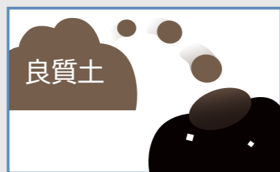
(2) MT 処理土に良質土を混合する
